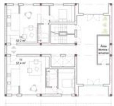
Bloco A - Planta piso 0 e piso tipo • 1,200
